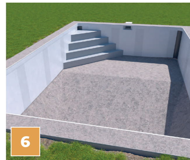
6 BÉTONNAGE SIMULTANÉ DU BASSIN ET DES JAMBAGES DE L'ESCALIER
