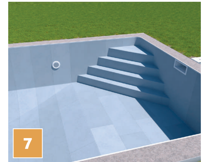
7 POSE DES MARCHES D'ESCALIER ET DU FEUTRE
