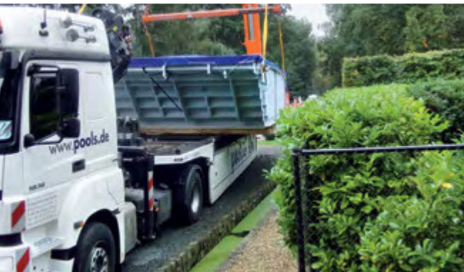
La piscine arrive entièrement carrelée à destination.
