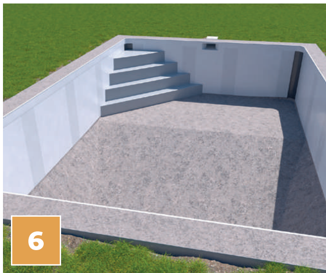
BÉTONNAGE SIMULTANÉ DU BASSIN ET DES JAMBAGES DE L'ESCALIER
